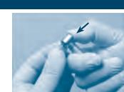
La fresa debe llegar siempre al tope para obtener una fijación correcta. Use fresas de buena calidad y normalizadas.
